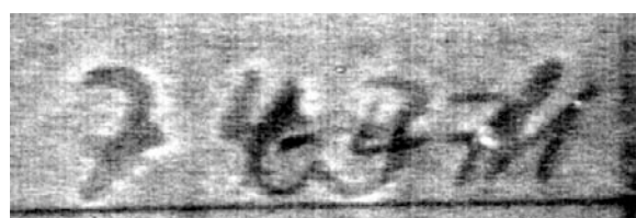
Abbildung 38 Eurocheck, rückseitige Kartennummer, Sichtbarmachung der Originaleintragung (,7431') durch Rot-IR-Lumineszenz und blau-grünem Filter (RG 780)
