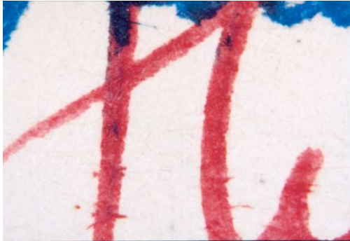
Abbildung 43 Strichkreuzung zweier Unterschriften, blauer Tintenroller mit roter Tusche überschrieben; Detailaufnahme; 20fache Vergrößerung Deutlich sichtbar ist die rote Unterschrift über die noch blaue gesetzt. Dabei wurden noch feuchte Bestandteile mitgezogen (schwarze Flecken)
