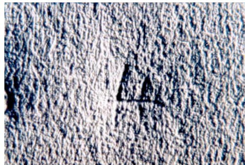
Abbildung 48 Darstellung der Eindruckspur im Streiflicht bei 8facher Vergrößerung Nach dem vollständigen Wegradiieren des Buchstabens mittels Radiergummis werden im Streiflicht die Umrisse wieder sichtbar.
