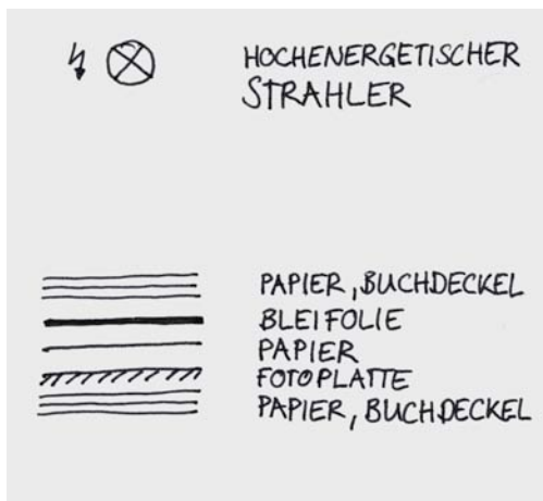
Abbildung 66 elektronenradiographische Untersuchung, schematische Darstellung der Arbeitsweise
