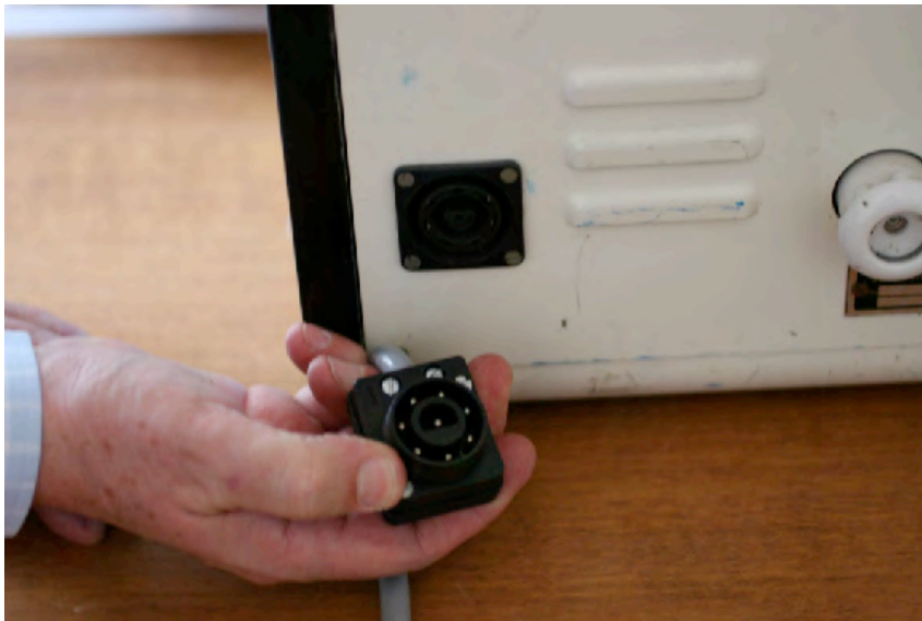
7. Zweites Kabelende mit Steckdose an der Rückseite des Transformators verbinden.
