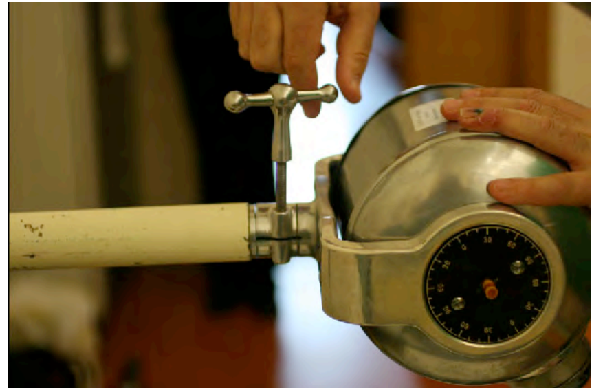
4. Feststellschraube festziehen, Röntgenkopf hierzu waagrecht ausgerichtet halten.
