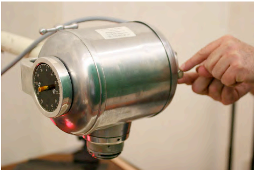
5. Röntgenstrahlaustritt senkrecht zur Arbeitstischoberfläche ausrichten und ggf. mittels Schraube fixieren.
