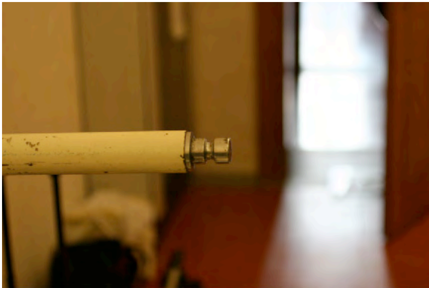
1. Stativ mit Stativarm in den Stativ Fuß stecken. Der Stutzen für den Röntgenkopf sollte hierbei gut erreichbar sein.
