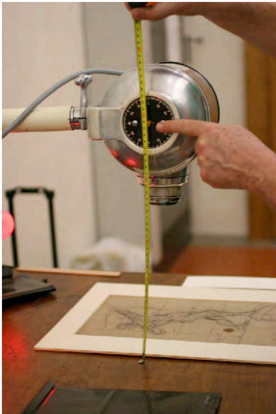
9. Einstellen des richtigen Abstandes Objekt-Röntgenkopf (33 - 39 cm).
