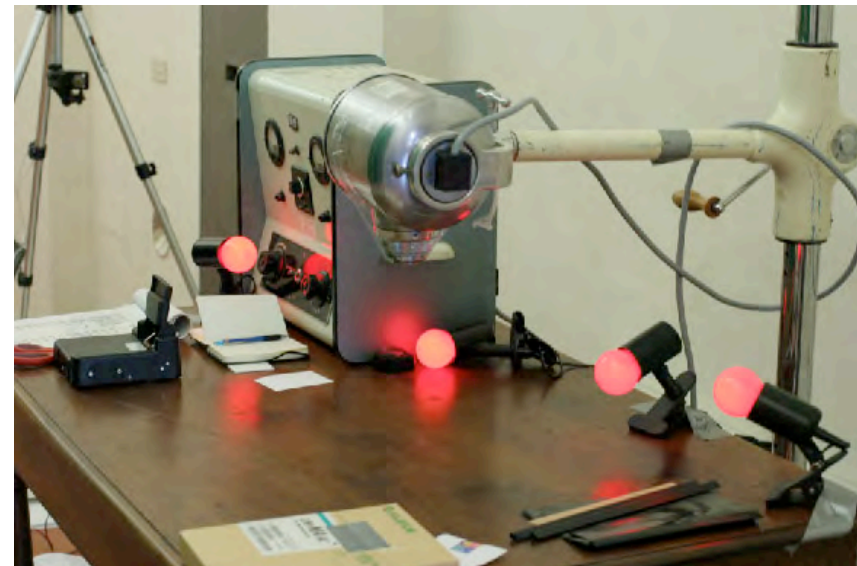
10. Lichtkontrolle; die Bedienbarkeit muß unter alleinigem Rotlicht ohne Einschränkungen und Komplikationen möglich sein.
