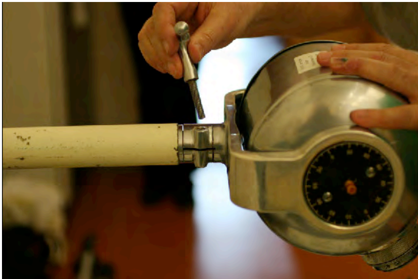
3. Röntgenkopf aufstecken, sodass die Feststellschraube eingeschraubt werden kann
