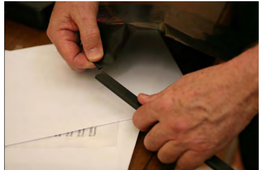
6. Öffnung des Foliensackes einschlagen und diesen mit der Plasikklemme verschließen.
