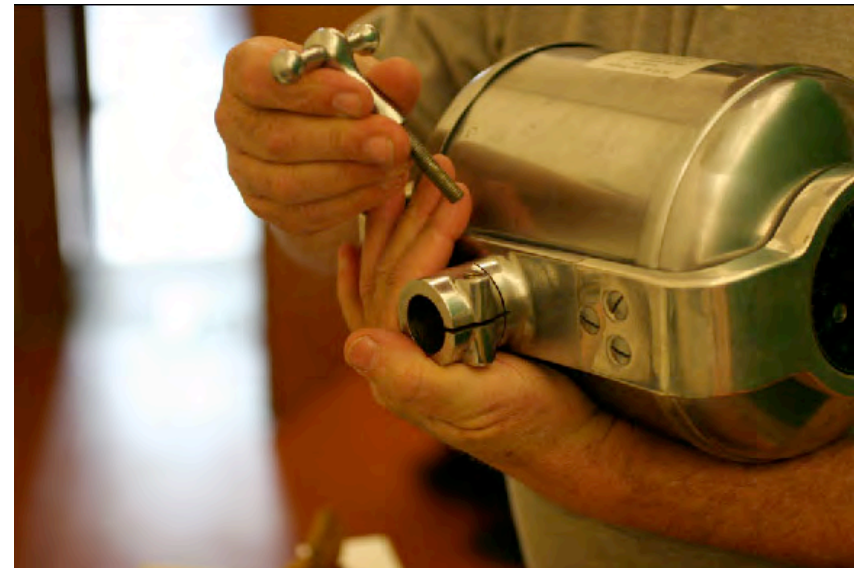
2. Feststellschraube vom Röntgenkopf lösen.
